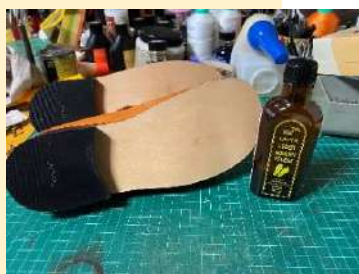
▲▶スニーカー風の場合。かかとやソールとなる木製の板とつま先を補強する先芯をラストに沿った癖をつける。その間にラストに合わせた本体の革パーツを作製。手作業で縫い進め、靴の形を作っていく。専用の接着剤で芯をつけて補強していく。最後にオイルを塗り加工したら完成。
