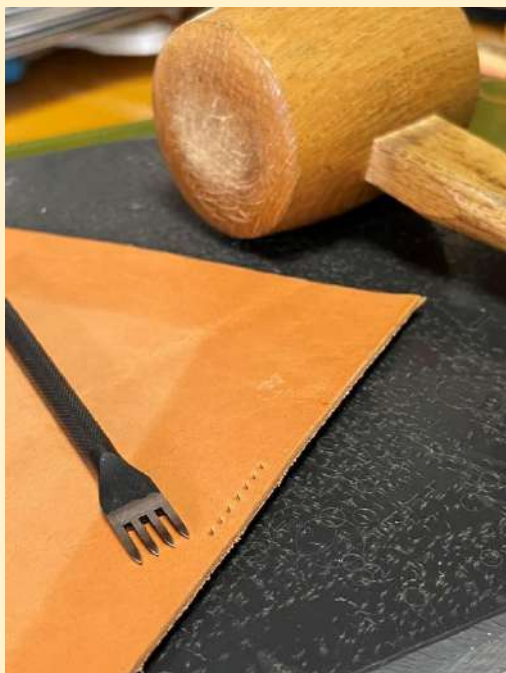
▲菱目打ちで革に穴をあけていく。先端を革に当て、上からハンマーで打ち付けていくと、小さな穴が等間隔にあく。これを縫い目として手作業で糸を通していく。
