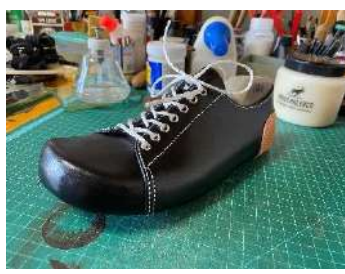
▲▶スニーカー風の場合。かかとやソールとなる木製の板とつま先を補強する先芯をラストに沿った癖をつける。その間にラストに合わせた本体の革パーツを作製。手作業で縫い進め、靴の形を作っていく。専用の接着剤で芯をつけて補強していく。最後にオイルを塗り加工したら完成。
