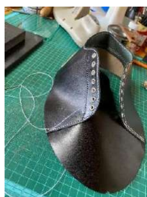
▲▶スニーカー風の場合。かかとやソールとなる木製の板とつま先を補強する先芯をラストに沿った癖をつける。その間にラストに合わせた本体の革パーツを作製。手作業で縫い進め、靴の形を作っていく。専用の接着剤で芯をつけて補強していく。最後にオイルを塗り加工したら完成。
