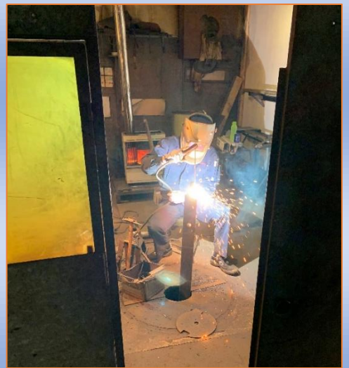
部品の溶接作業
